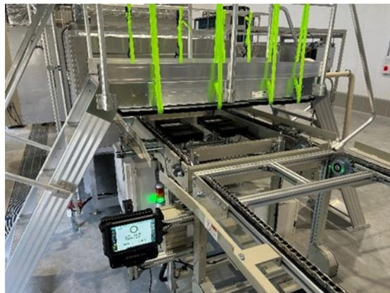
RFID(電子タグ)により洗浄履歴を記録
